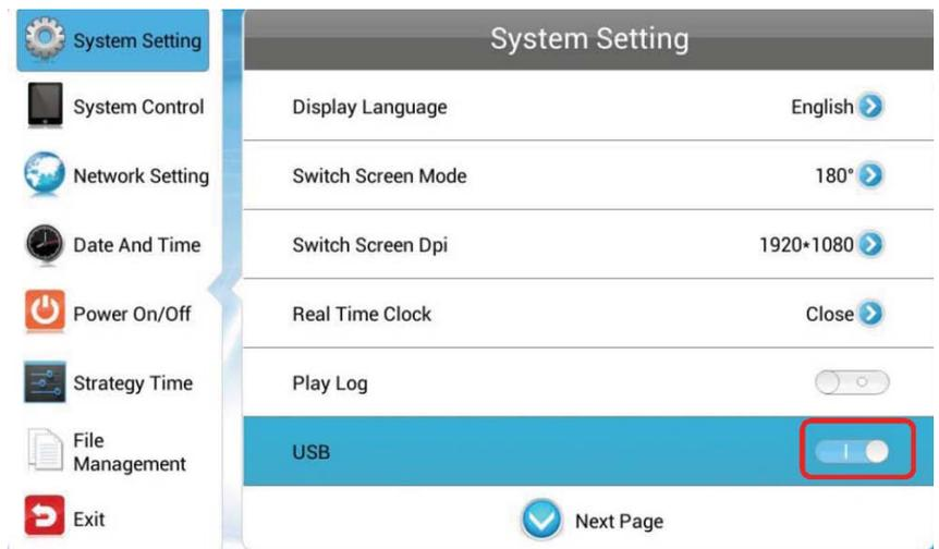
各項目を選択・変更するにはブルーのハイライト表示を矢印キーで移動させ、再生ボタンで項目を変更させることができます
