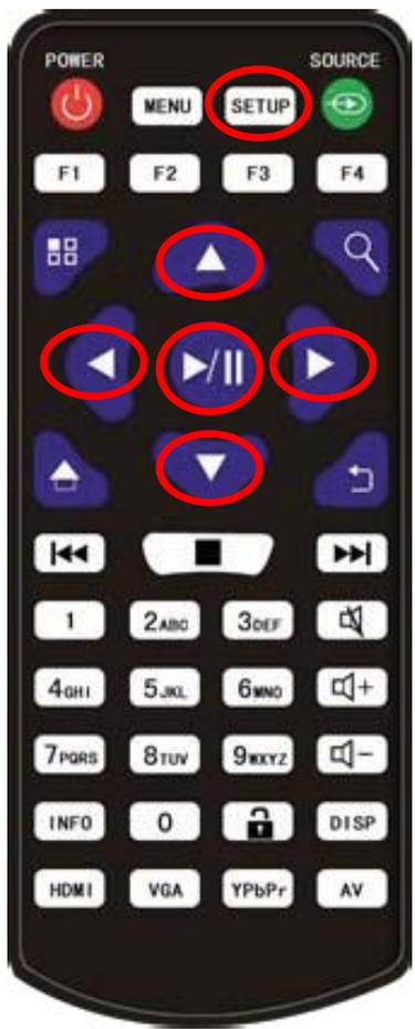
リモコンの Setup ボタンを押して System Setting のメニューを表示させます
