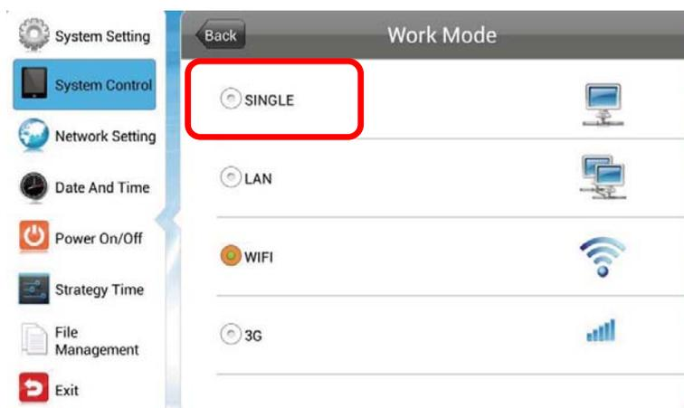
System Control の Work Mode を SINGLE に設定します
