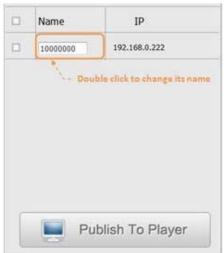
どのサイネージか簡単に認識できるようにサイネージの名前をデフォルトの Machine number を変更するにはリストアップされている Name をダブルクリッ クします。
