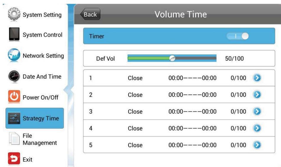
Timer を選択し、リモコンの再生ボタン
