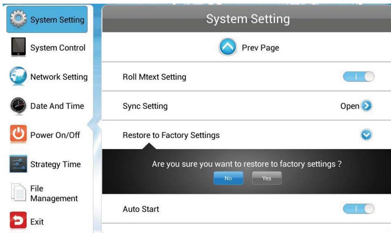
Restore to Factory Setting を選択するとメッセージが表示され Yes で System Setting の設定が工場出荷状態に戻ります
