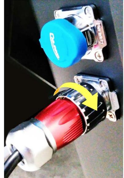
**【注意】：AC アダプターの接続は、最初に本機の電源を OFF し、次にコンセントを接続します。AC アダプターの LED が緑に点灯したことを確認し、上図の「アダプター端子（赤色端子）」を本機に「電源コネクター」に接続すること。**
